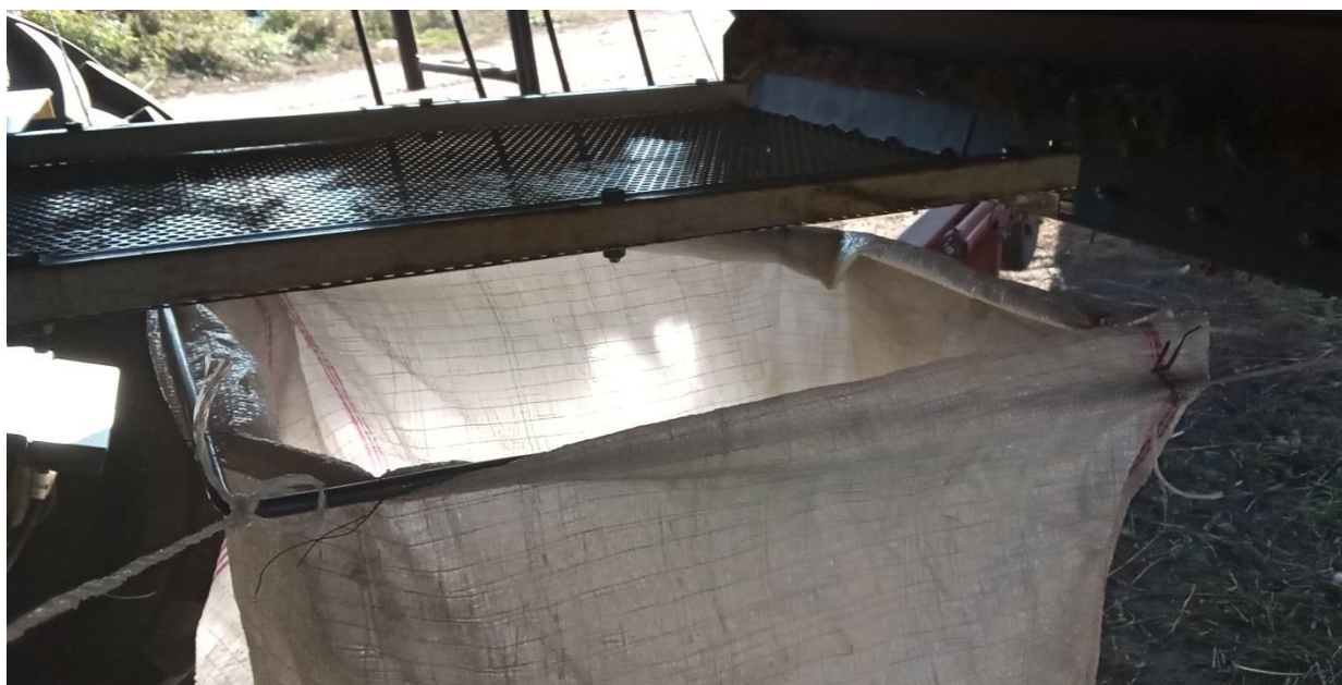
Рис. 3. Навешенный консольно на комбайн ACROS 585 вариант уловителя перед экспериментом: решето (с боковинами из металлической трубы 20х20х1,5 мм) над матерчатой ёмкостью для сбора прохода через отверстия в решете семян сорняков, половы и коротких соломин
