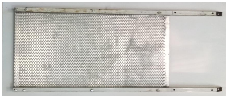
Рис. 2. Решето варианта экспериментального уловителя с боковинами из металлической трубы 20х20х1,5 мм
