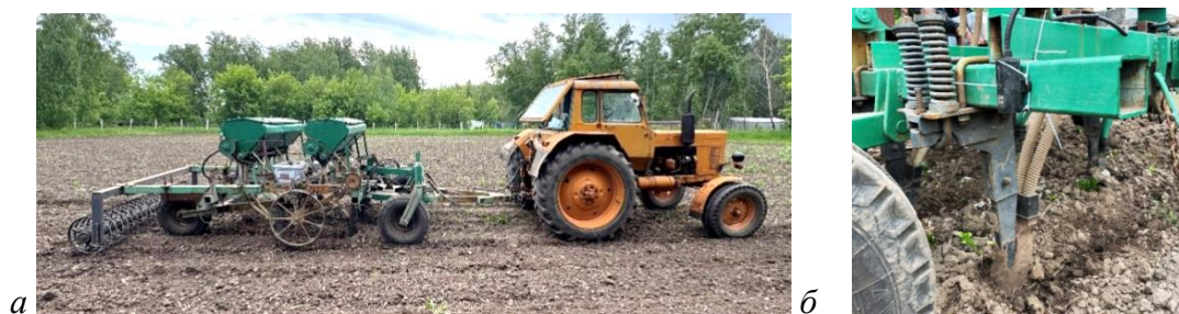
Рис. 2. Посевной агрегат МТЗ-80Л с ППМ -2,5-3Т (а) и датчик Escort ДГВ-200 на машине (б)
