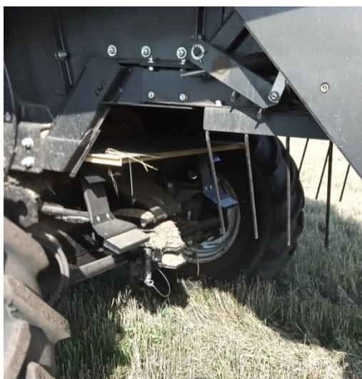
Рис. 1. Зерноуборочный комбайн ACROS 585 (вид слева на заднюю часть системы очистки зерна и плоский стальной удлинитель верхнего жалюзийного решета в виде стола (с соломиной), под которым виден датчик потерь зерна)
