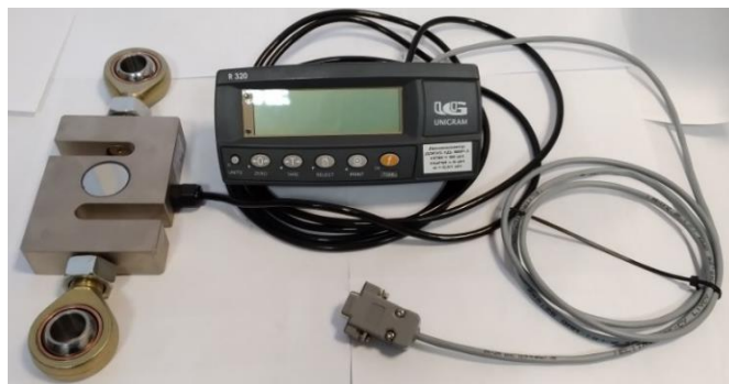
Рис. 2. Динамометр ДЭП/3-1Д-50Р-2 для определения тягового сопротивления рабочих органов при обработке почвы
