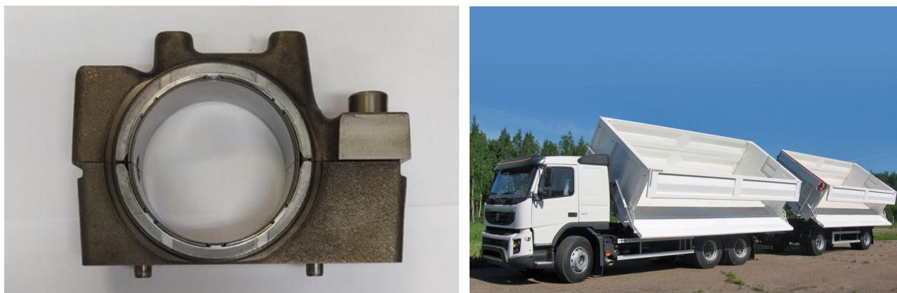
Рис. 1. Постель распредвала двигателя VOLVO серии D13 (а) и зерновоз VOLVO FMX с двигателем VOLVO D13 (б)
