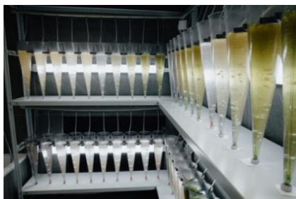
Рис. 2. Инкубация в седиментационных конусах
